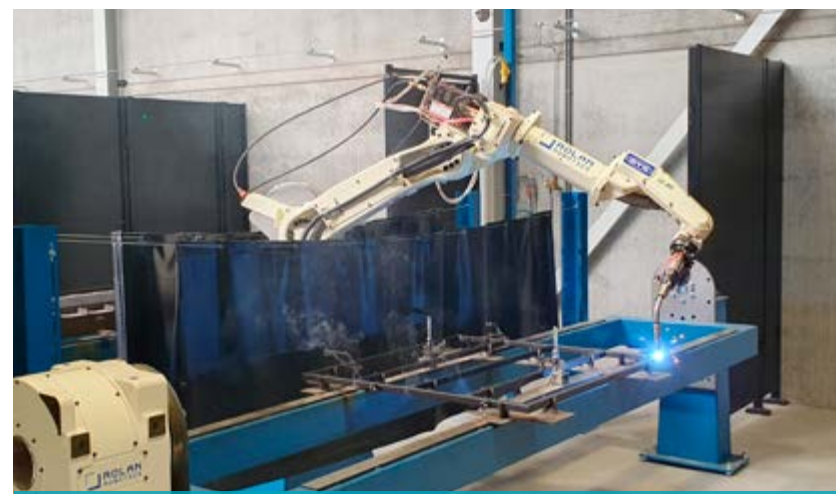
Bij de robotarm FD-B6L zit het slangenpakket binnendoor, wat veel bewegingsvrijheid geeft bij het maken van constructiedelen van kokerwerk.
